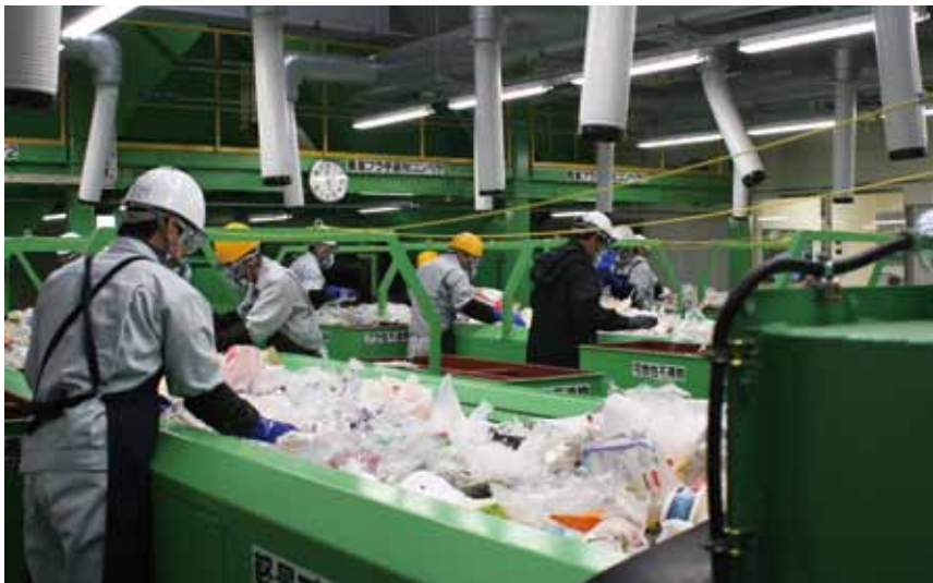
▲ごみを処理ラインに乗せての試運転。手作業で異物を取り除きます。
